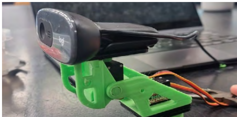
O protótipo, com modelo de sistema de movimentação encontrado na internet e impresso em 3D, e servo-motores conectados a uma placa controladora Arduino Uno
